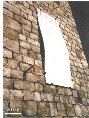
Plaque commémorative en calcaire lithographique ayant subi, en raison de son poids, un fluage plastique (abbaye des Récollets de Saverne, cliché A. Lardon).
