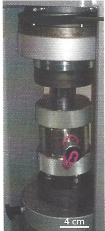
▲ FIGURE 23. Presse triaxiale . D'après DAUTEL et al. (2021) et PERRIER, BEAUX et al. (2008).
