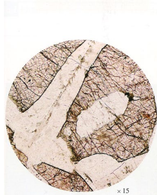
b. Lame mince de gabbro observée en lumière polarisée non analysée.
