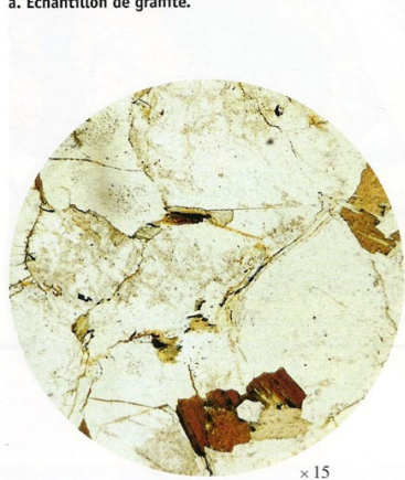
b. lame mince de granite observée en lumière polarisée non analysée.
