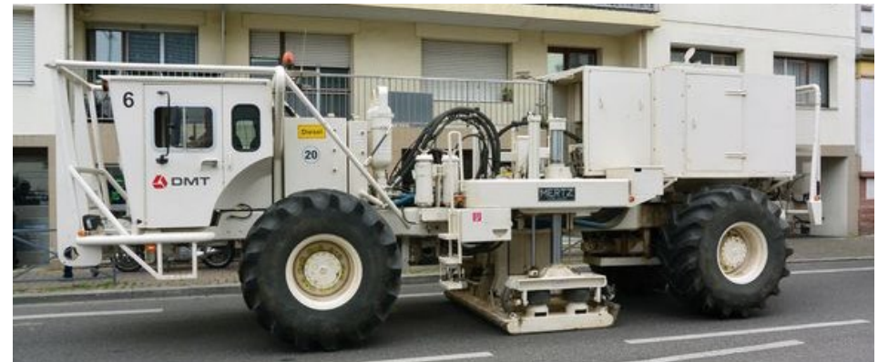
▲ FIGURE 49. Un camion vibreur. https://www.lemoniteur.fr/article/des-camions-vibreurs-echographient-la-ville-de-strasbourg.812829 (consultation janvier 2022)
