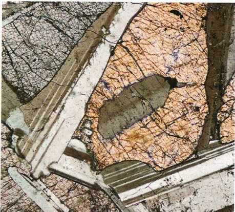
c. Lame mince de gabbro observée en lumière polarisée analysée.
