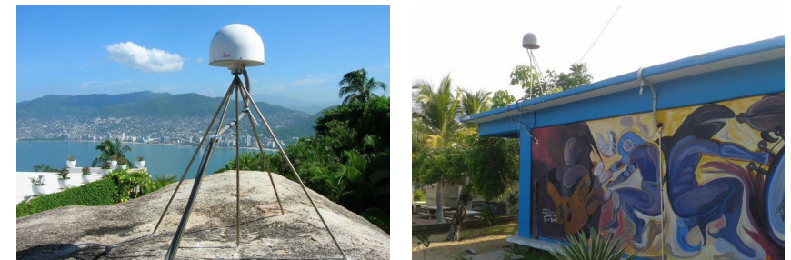
▲ FIGURE 5. Stations GPS permanentes à Papano et Acapulco (Mexique). https://newsroom.univ-grenoble-alpes.fr/sciences-et-technologies/les-seismes-lents-peuvent-declencher-des-secousses-103171.kjsp (janvier 2022).
