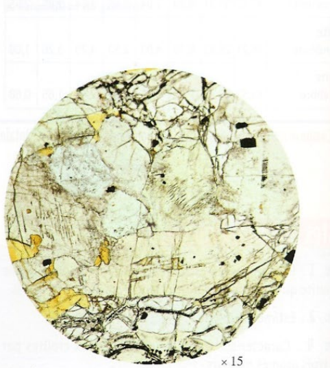
b. Lame mince de péridotite observée en lumière polarisée non analysée.
