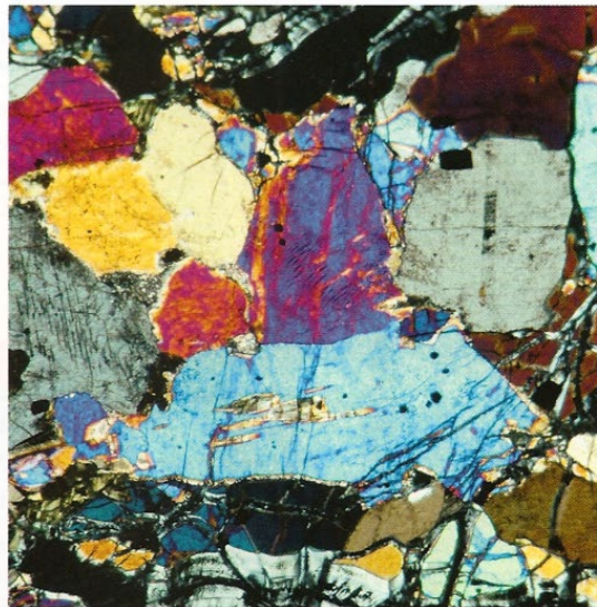
c. Lame mince de péridotite observée en lumière polarisée analysée.
