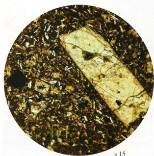
b. Lame mince de basalte observée en lumière polarisée non analysée.
